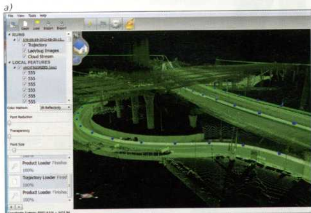
Элементы результатов работы мобильной картографической системы Торсон IP-S 2 :
