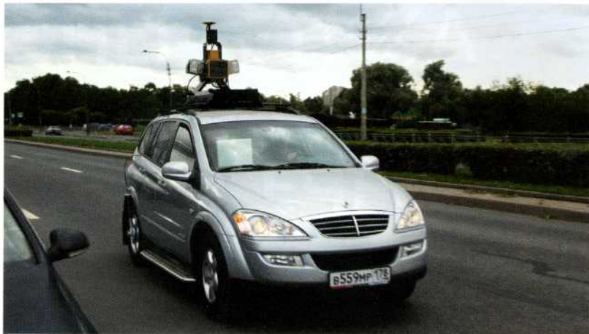
Мобильная картографическая система TopCon IP-S 2 , установленная на автомобиле
