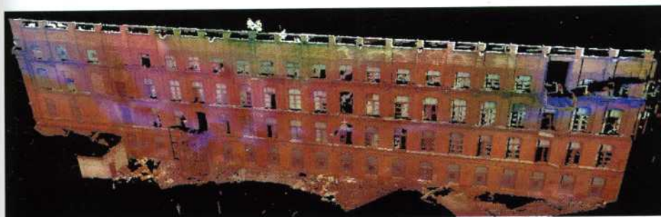
Результат лазерного сканирования фасада здания по Литейному пр., 26. «Облако точек» с наложением фотоизображения
